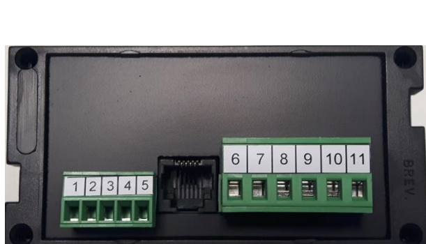
Obr. 4 Zadní panel přístroje- základní svorky
